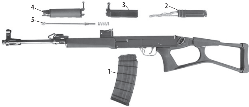
Fig. 26 The Sa vz. 58 Sporter partially disassembled
